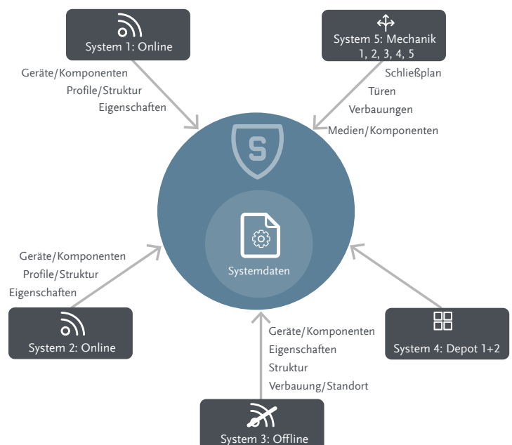
Abbildung: Alle relevanten Systemdaten aus angeschlossenen Zutrittssystemen (Schließanlagen) werden zu .secure übertragen.
